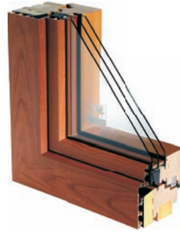
Ultratherm Basic L'épaisseur du profilé de 122 mm / 125 mm, Uw à partir 0,67 W/m²K.
