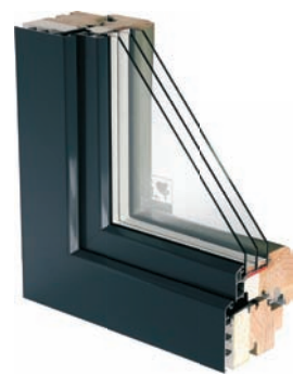
Ultratherm Classic L'épaisseur du profilé de 114 mm, Uw à partir 0,71 W/m²K.
