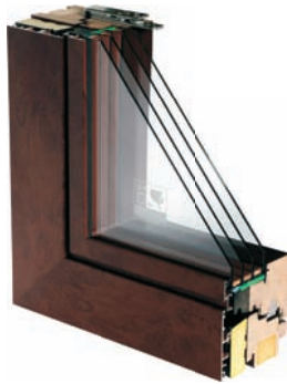
Ultratherm Ultima L'épaisseur du profilé de 122 mm / 125 mm, Uw à partir 0,67 W/m²K.
